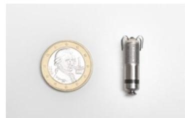
Größenvergleich: Die Micra-Kapsel ist etwa so groß wie ein 1-€-Stück und etwa zehnmal kleiner als ein herkömmlicher Schrittmacher.
